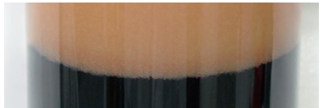
Идеальное разделение катионита и анионита в ФСД
